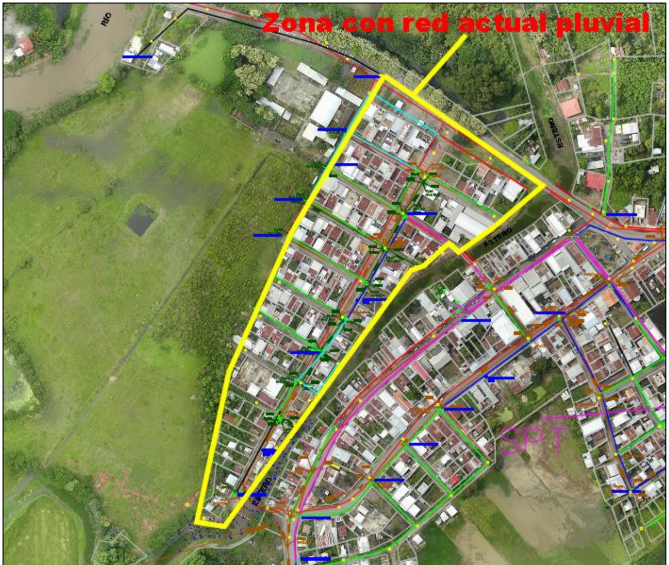
Ilustración 3 Zona con red de alcantarillado pluvial que se inunda en época invernal
